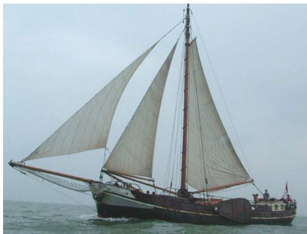
▲ Aak in navigazione. Si distingue una delle pali laterali di deriva e la caratteristica armatura con bompresso , secondo fiocco tangonato e bomato, randa aurica
