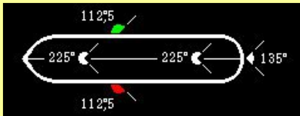
posizione dei fanali e gradi di visibilità
