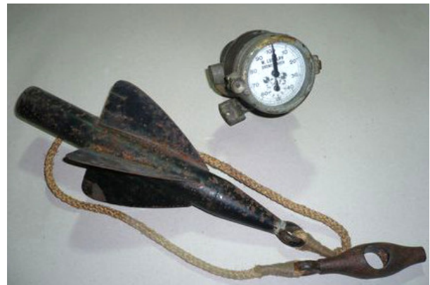
▲ Solcometro ad elica degli inizi del XX secolo; da filmatidimare.altervista.org/
