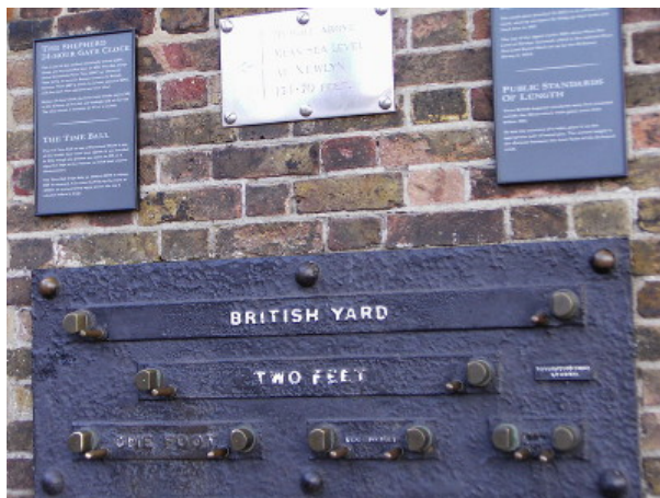
▲ Targa all'osservatorio di Greenwich di misure inglesi, fra cui la yard; da wikipedia
