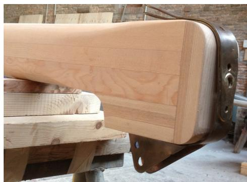
Tutti i fori della ferramenta sono stati sigillati con cunei della stesso legno e FLX. CORES ci ha poi portato il prodotto per l'impregnazione J50 (resina acrilica monocomponente) e per la finitura URETAN NR (Poliuretano a solvente ad effetto lente sottile), che con poche mani applicate bagnato su bagnato hanno consentito di isolare per i prossimi vent'anni il legno del albero.
