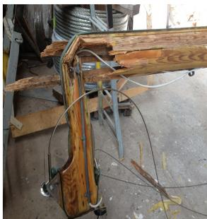
Il giorno che l'albero viene levato, Beppe non c'è! Non può raccomandarsi per la sua creatura e capita il peggio: malamente imbragato l'albero rimane appeso per la parte ammalorata. La testa d'albero si spezza e sedici metri di un'opera d'arte cadono tra cavalletti e scali. Beppe conosceva il RURIK da alcuni anni. Avevano fatto tardi insieme diverse sere sul piccolo naviglio.
