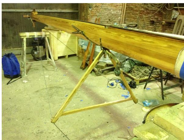
La ferramenta è stata rimontata isolando ogni vite ed ogni placca con polimero perché una buona parte dei malesseri del legno ha origine nei fori della ferramenta che costituisce una via per l'acqua all'interno del legno passando i trattamenti. Rimontate le sartie, il diamante, passate le drizze e imbragato alla presenza di Beppe, l'albero è tornato in sede.
